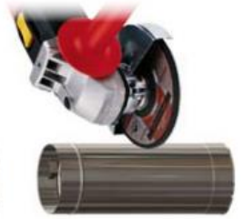
Abb. 05, Rohre kürzen u. entgraten
