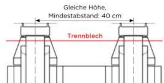
Bild 27b: Mündungshöhe und Abstände
