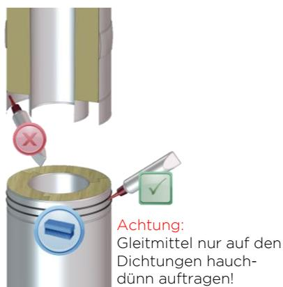
3. Längenelemente zusammenstecken und Steckverbindung mit Klemmband sichern
