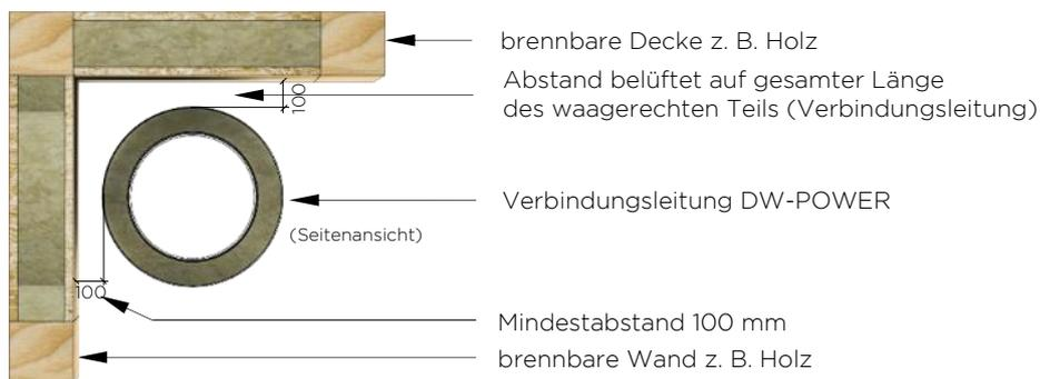
Bild 4-3: Einbau als Verbindungsleitung bis T600
