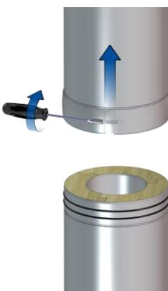
2. Steckverbindung und Dichtung müssen sauber sein. Anschließend Dichtungen **hauchdünn** mit Gleitmittel benetzen
