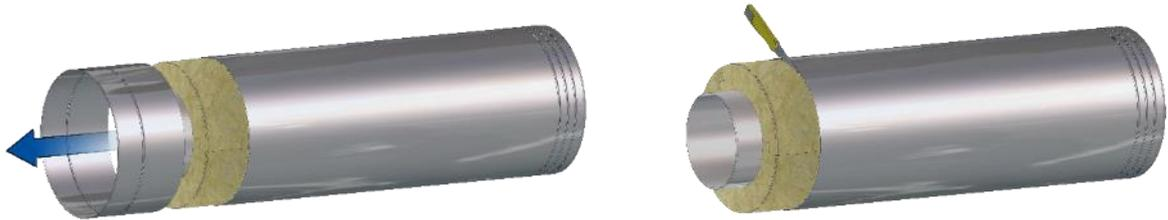
4. Innenrohr mit einem Winkelschleifer durchtrennen.
