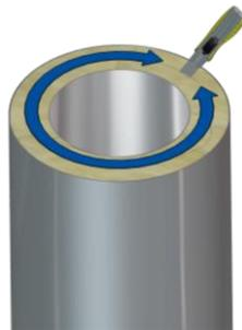
2. Dämmung mit Hilfe einer Bohrmaschine und des Isolierschneiders durchtrennen.
