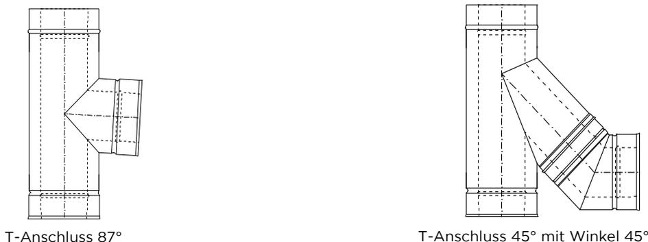
Bild 10: Anschluss für Verbindungsstück an der senkrechten Abgasanlage
