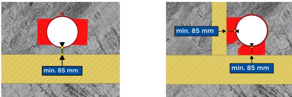
Bild 5-11: Wandabstände Konsolen im Rohbau
