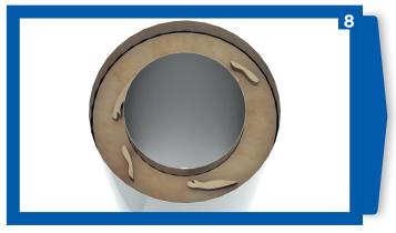
Der Abstand zwischen Dämmung und Außenkante darf max. 60mm betragen!
