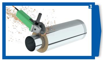
Innenrohr mit dem Winkelschleifer durchtrennen.
