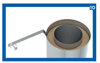
Um Schäden an den Dichtungen zu vermeiden, ist es wichtig, die Schnittkante des Außenrohres zu entgraten und leicht nach außen zu biegen. Hierzu wird die auf der Außenseite des ISO-Schneiders angebrachte Vorrichtung verwendet.
