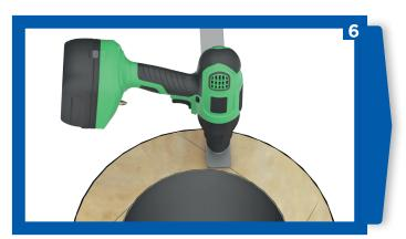
Mit Hilfe des DW-POWER ISO-Schneider die Dämmung auf der gekürzten Seite durchtrennen.
