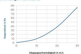
$^{2}$  Exemplarischer Widerstandsverlauf (Widerstandsbeiwert 0,2 / 100 °C) (Der Strömungswiderstand ist abhängig von der Abgasgeschwindigkeit) Hier handelt es sich um theoretisch berechnete Werte.
