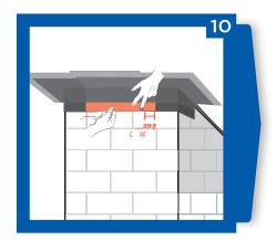
Der Klebekragen wird mindestens 3 cm überlappend an der WinkelECK Manschette und an dem Bauteil befestigt.
