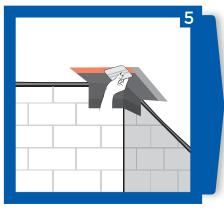
Die Klebefläche mit einem festen Hilfsmittel, z.B. Rakel, auf dem Bauteil andrücken.
