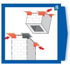
Alle vier WinkelECK Manschetten müssen nach dem gleichen Prinzip angebracht werden. Bitte achten Sie speziell auch auf die angelegten Dachschrägen.
