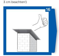
Das Anschlussband muss an allen vier Seiten nach dem gleichen Prinzip verbaut werden. Bitte achten Sie speziell bei Dachschrägen auf die erforderliche Überlappung von mindesten 3 cm.
