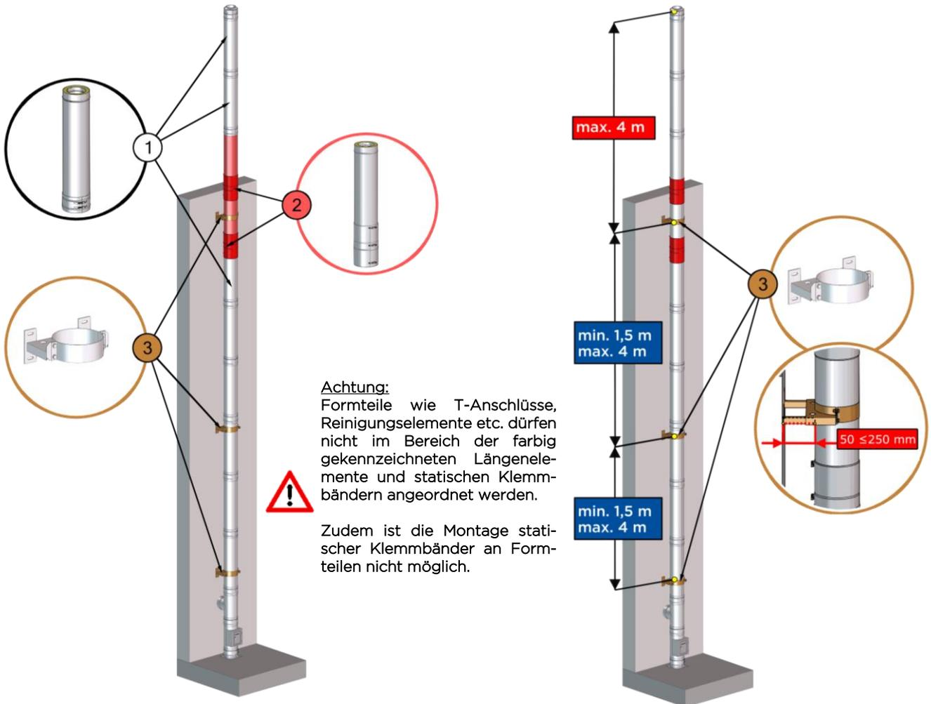
Bild 2-1: Bauteilübersicht
