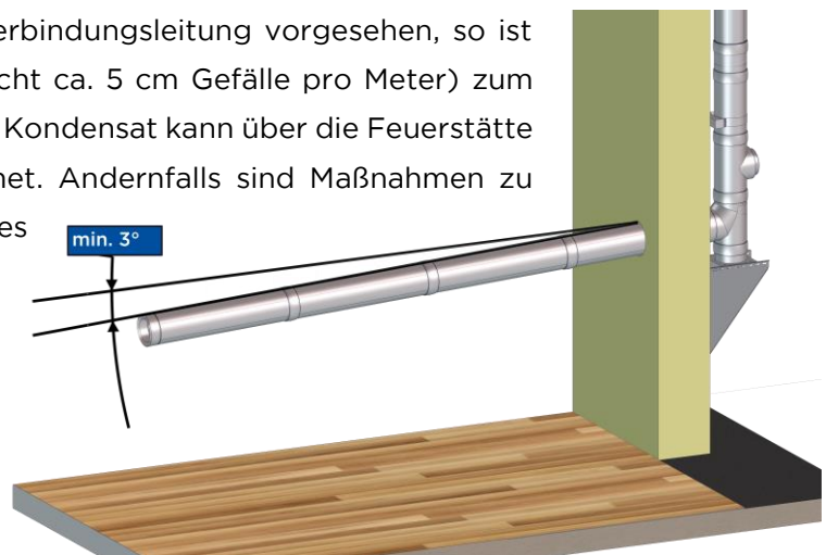
Bild 6-1: Notwendiges Gefälle (feuchte Betriebsweise)
