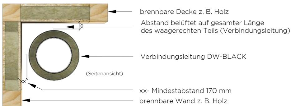
Bild 4-2: Einbau als Verbindungsleitung bis T450
