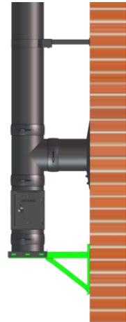
Bild 5-4: Aufbau Grundplatte mit Kondensatablauf und Wandstütze „schenkelabwärts“
