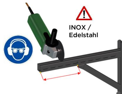
Die Länge der Wandstütze kann durch Kürzen angepasst werden.
